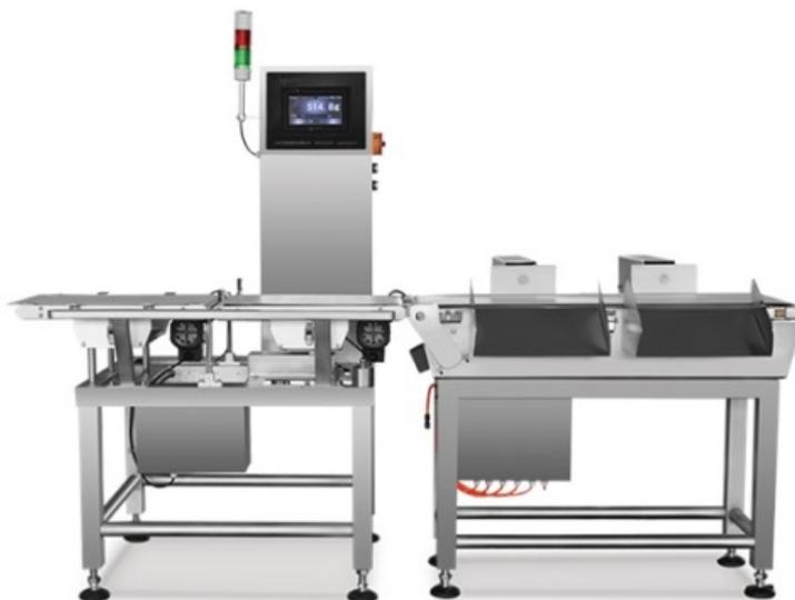
Чеквейер (от английского checkweigher – контрольные весы) или система динамического взвешивания, предназначен для взвешивания продуктов, движущихся по технологической линии, распределяет их согласно заданным весовым зонам и сортирует или отбраковывает эти продукты в соответствии с их классификацией.
